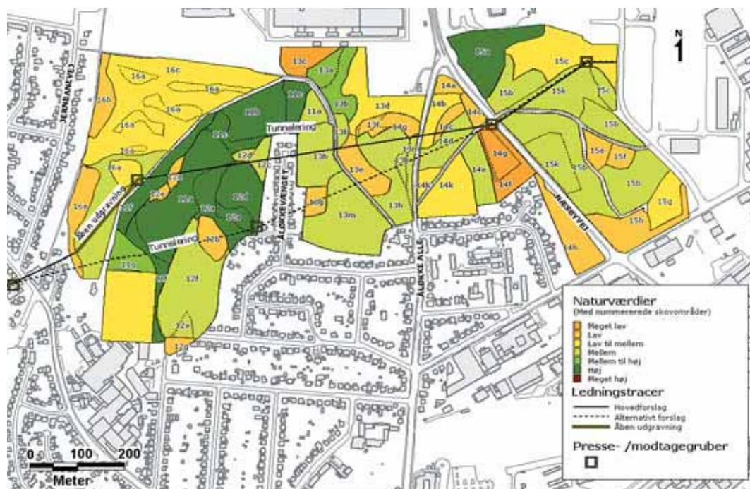
Eksempel på kortlægning af naturværdier ved et anlægsprojekt.
